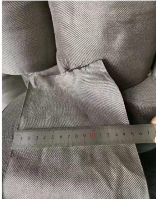
1. 耐高温(>650℃) 2. 电阻小、导电性佳 3. 耐腐蚀 4. 耐清洗 5. 稳定的导电性能 产品说明 柔软不锈钢纤维是多种金属纤维制品的原材料与其它纤维性质比较，其抗拉强度及切断强度大，熔点高可以使用于高温的环境，电阻小，热传导性佳。材质:SUS316L 直径:6, 8, 12, 22微米 耐温:650℃，熔点:1350℃ 特色 柔软不锈钢纤维是多种金属纤维制品的原材料与其它纤维性质比较，其抗拉强度及切断强度大，熔点高可以使用于高温的环境，电阻小，热传导性佳 应用 不锈钢纤维由于其高精度的加工工艺，使其在众多的使用领域中表现优异，其主要泛应用于纺织、过滤、耐高温、导电、导热等涵盖工业、民用、的各个领域 不锈钢短纤通过不锈钢丝材复合组装，多次集束拉拔、退火、固溶处理等一套特殊工艺制成，每股有数千、数万根。不锈钢纤维表面积非常大，使其在内部结构、磁性、热阻和熔点等方面有着超常的性能。不锈钢纤维丝径可达1-2微米，延伸率大于1%，纤维强度可以达到1200-1800Mpa
